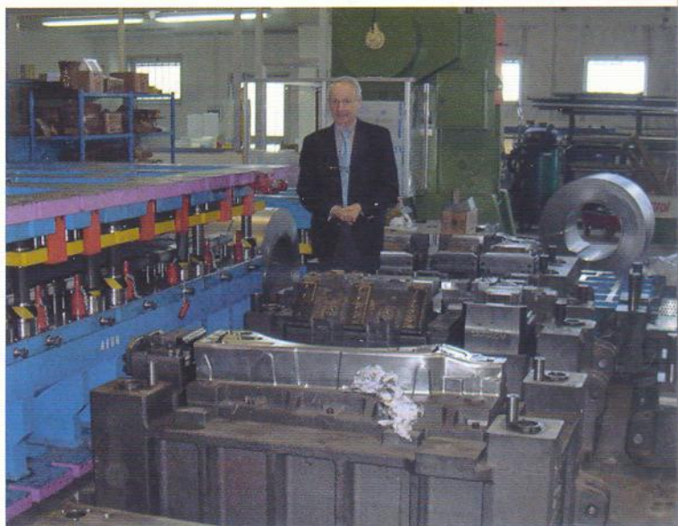
Fig. 2 Lo stampo sotto la pressa (sotto, a destra) e il grande stampo, a passo, nell'officina della Meccanotecnica Centro: nella foto, l'ing. Bravetti, presidente dell'azienda.
