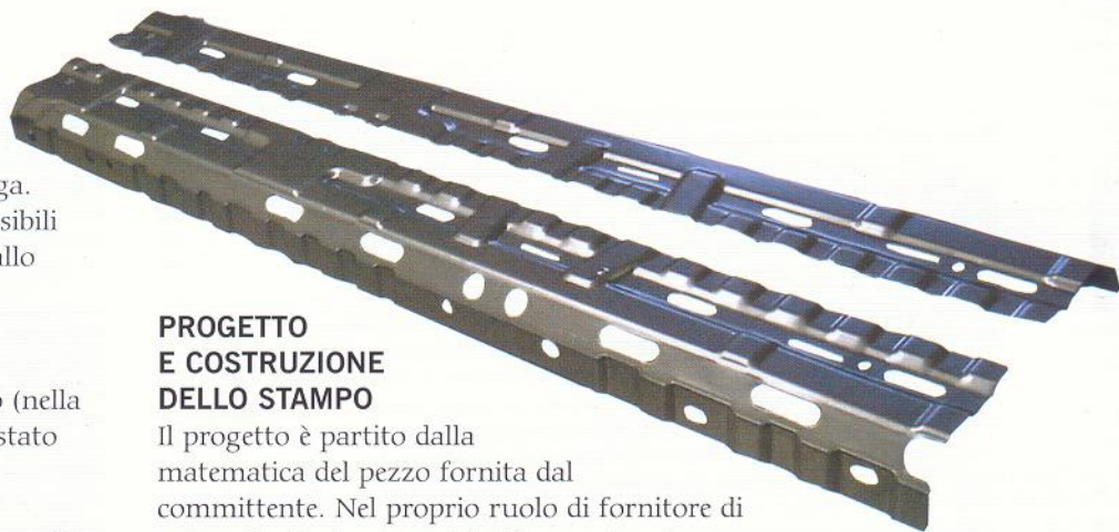
Fig. 1 Il "longherone" che fa parte della struttura resistente dell'auto Alfa Romeo 159.
