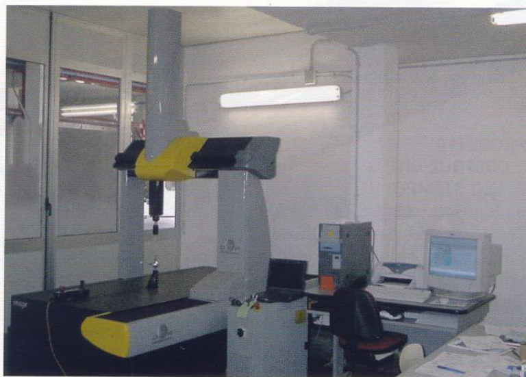
Fig. 3 La "striscia" relativa alla produzione dei longheroni descritti e un aspetto della sala metrologica della Meccanotecnica Centro S.p.A.: una cmm Dea permette i più rigorosi controlli geometrici e dimensionali sui pezzi di qualunque geometria e complessità.
