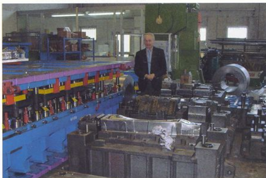
Fig. 5 Il grande stampo, a passo, nell'officina della Meccanotecnica Centro: nella foto, l'ing. Bravetti, presidente dell'azienda
